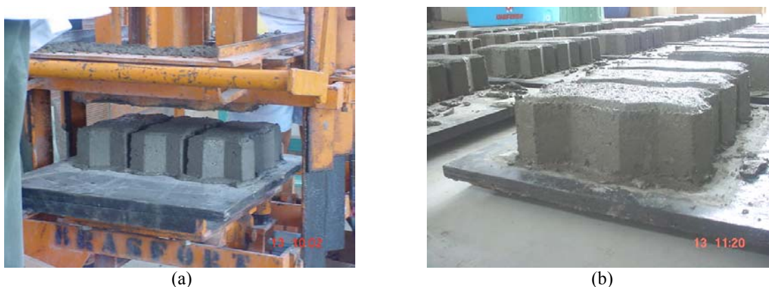
Figura 4 Produção dos pisos: (a) moldagem; (b) aspecto dos pisos após a moldagem
