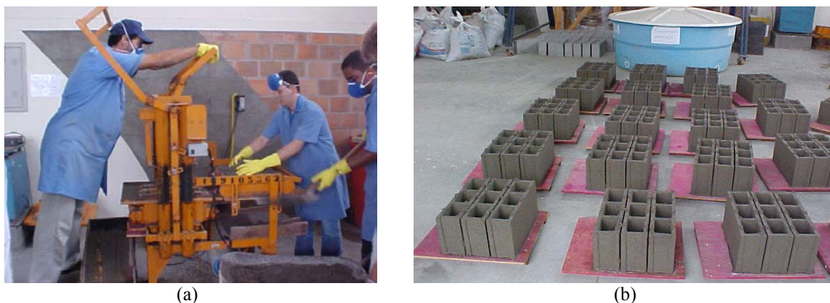
Figura 4 Produção dos blocos: (a) moldagem dos blocos de vedação; (b) aspecto dos blocos de vedação
