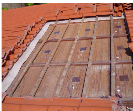
Figura 4 – Vista da localização dos transdutores
