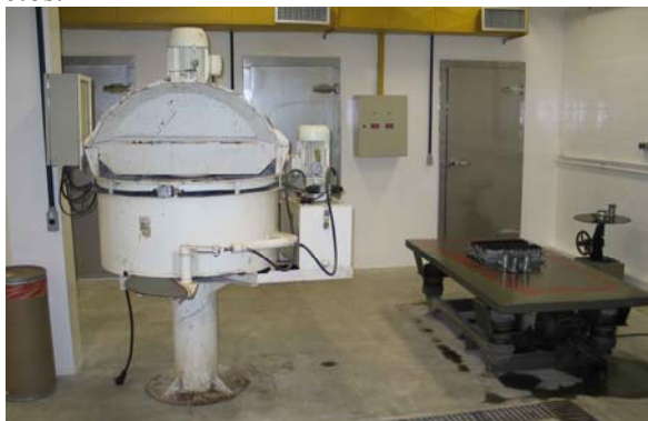
Figura 2. Misturador planetário e mesa vibratória utilizados no estudo
