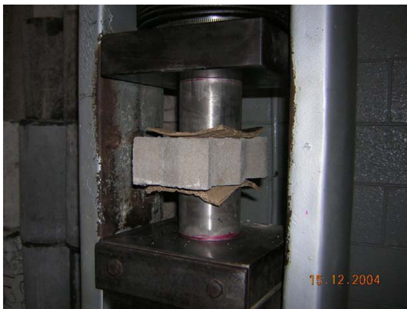
Figura 5 – Paver na prensa universal para ensaios.
