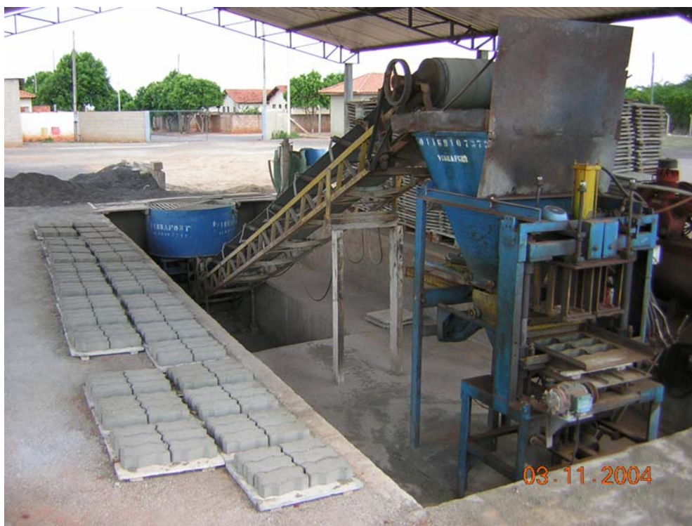
Figura 4 – Moldagem dos blocos na vibro-prensa semi-automática.
