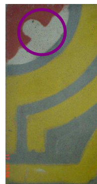
Figura 5 – Ladrilho com três camadas de impermeabilização após lavagem com água clorada
