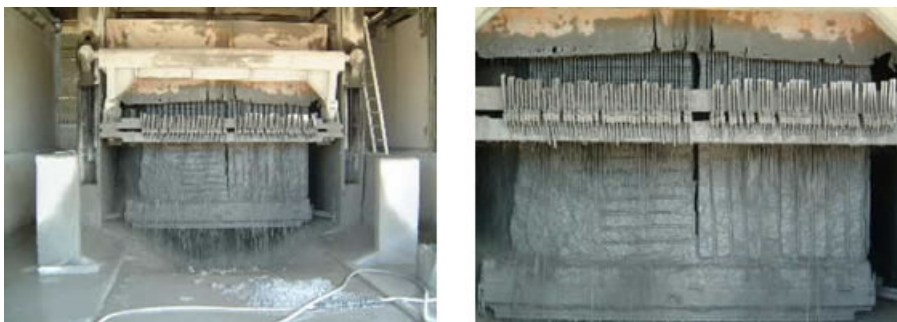
Figura 2 Corte dos blocos em teares na indústria beneficiadora.
