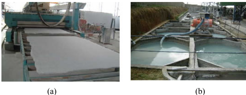
Figura 4 Polimento das chapas (a) e tanques de decantação (b) na indústria beneficiadora.
