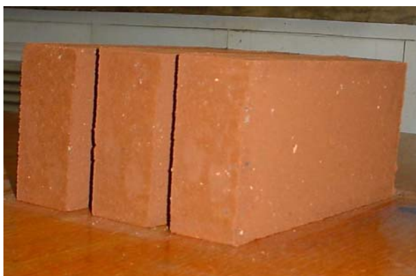
Figura 1 – Tijolos de solo-cimento com adição de ARC.
