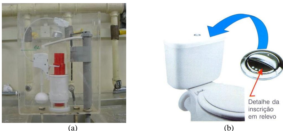
Figura 1 - Mecanismo de descarga Dual Flux, (a) montado em laboratório e (b) instalado em bacia sanitária de tecnologia VDR (DECA, 2004).
