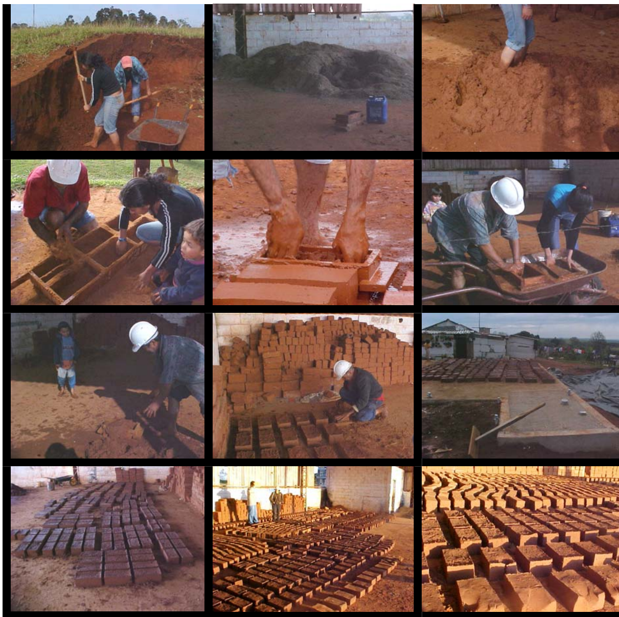
FIGURA 3 - FOTOS DA SEQUÊNCIA DE PRODUÇÃO DO ADOBE. CONSTRUÍDA (FONTE: GRUPO DE PESQUISA HABIS, 2004)
