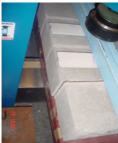
Figura 4 – Prisma rompido fora do terço médio: amostra desconsiderada
