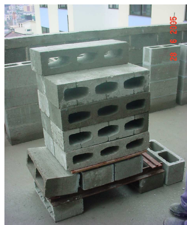
Figura 6 - prisma rompido na primeira e na terceira junta
