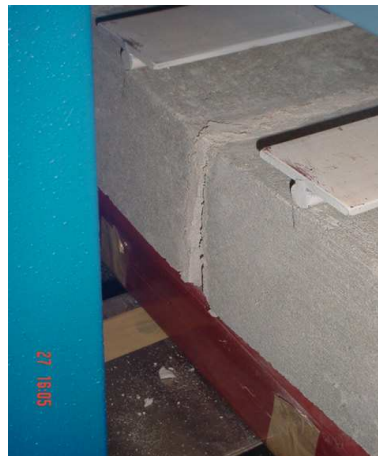
Figura 3 – Rompimento no terço médio do prisma.
