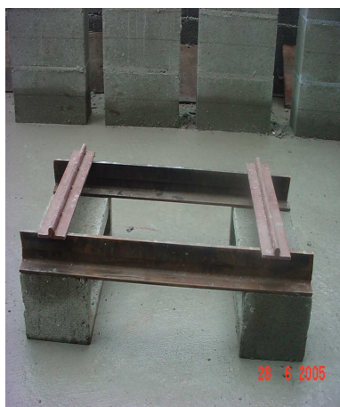
Figura 5 - aparatos utilizados para o rompimento dos prismas em obra
