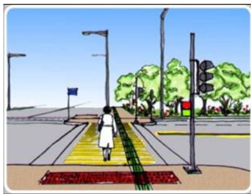
Figura 02 – Travessia de via veicular elevada, com alargamento de passeios.
