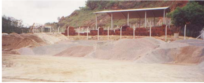
Figura 4 - Contaminação dos agregados
