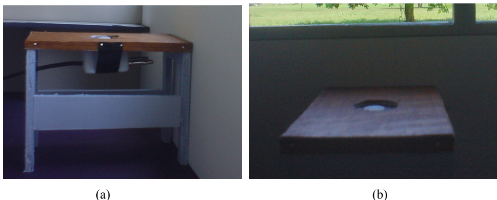
Figura 5 – Foto do detalhe de fixação da fotocélula na bancada do modelo reduzido vista lateral (a) e vista frontal (b).
