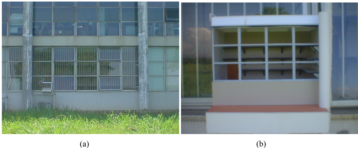
Figura 7. – Foto do posicionamento do modelo reduzido durante as medições (a) e foto aproximada do modelo reduzido (b)
