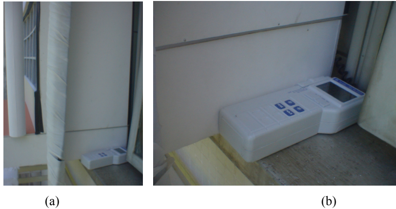
Figura 6 – Foto do detalhe da localização do leitor do luxímetro durante as medições (a e b).
