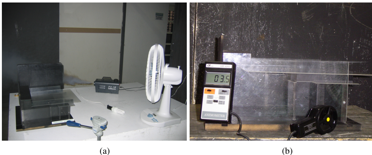
Figura 4: Equipamentos utilizados para simulação de distribuição de ar: (a) maquete, máquina de fumaça, ventilador, lâmpada fluorescente compacta e (b) anemômetro de ventoinha. (Fonte: RECH, 2005)
