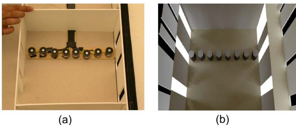
Figura 3. (a) Fotocélulas Li-Cor dispostas na Maquete. (b) Fotocélulas simuladas no modelo do APOLUX.
