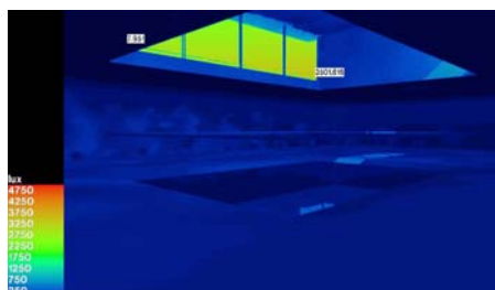
Figura 10 - Simulação com o sistema Okasolar nas superfícies iluminantes?: 22 de junho às 9h (céu claro).
