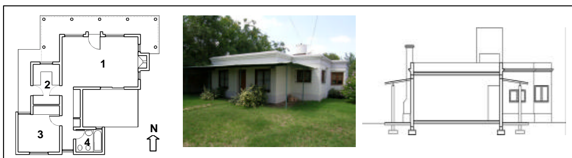
Figura. 1: Planta, corte y vista de la vivienda (1. Estar-comedor, 2. Cocina, 3. Dormitorio, 4. Baño).
