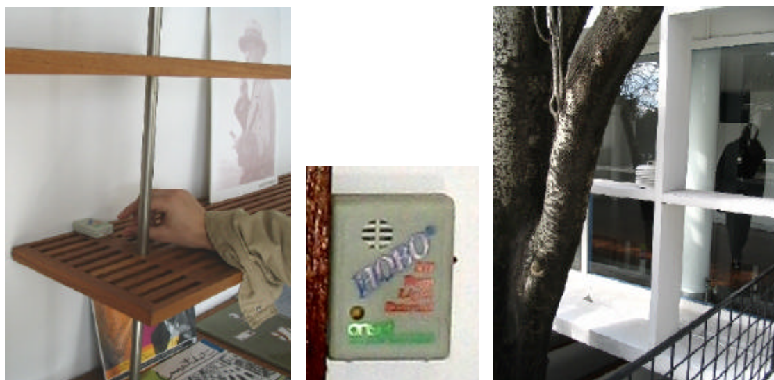
Figura 4: Detalle del microadquisidor de datos HOB0 y ejemplo de localización en el consultorio. A la derecha localización del resguardo meteorológico Hobo sobre el “brise soleil”.
