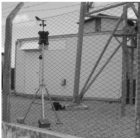
Figuras 04 e 05 – Dois tipos de equipamentos instalados. Uma estação meteorológica e um testor com proteção plástica.
