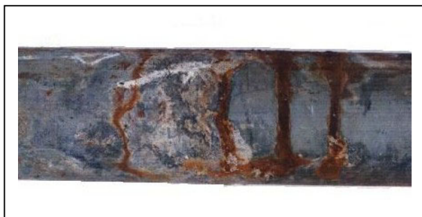
Fig. 8 – Corrosão de tubo zincado, mostrando a camada marrom de óxido férrico ( \text{FeOOH} ) e carbonato básico de zinco [ \text{Zn}(\text{OH})_2 \cdot \text{ZnCO}_3 ].
