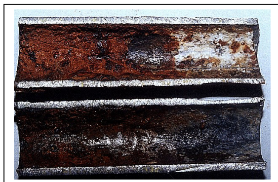
Fig. 10 – Aspectos de corrosão interna de tubos galvanizados.
