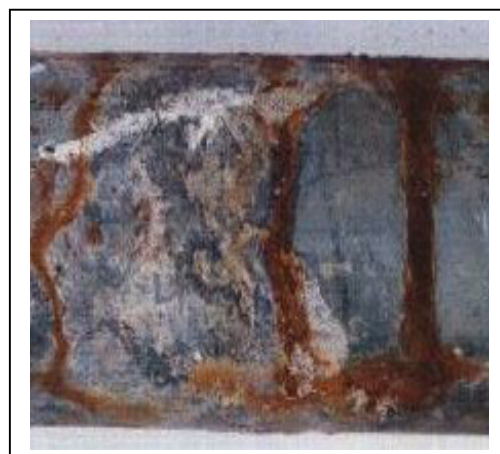
Fig. 8 – Corrosão de tubo zincado, mostrando a camada marrom de óxido férrico ( \text{FeOOH} ) e carbonato básico de zinco [ \text{Zn}(\text{OH})_2 \cdot \text{ZnCO}_3 ].
