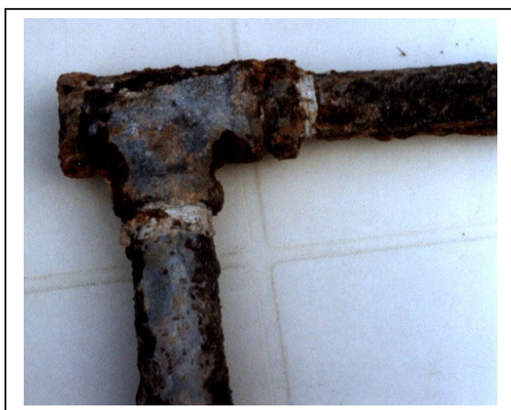
Fig. 9 – Corrosão externa de tubos galvanizados
