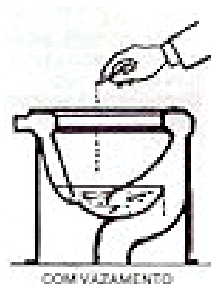
Figura 2: Teste da cinza de cigarro. Fonte: SABESP (s.d)
