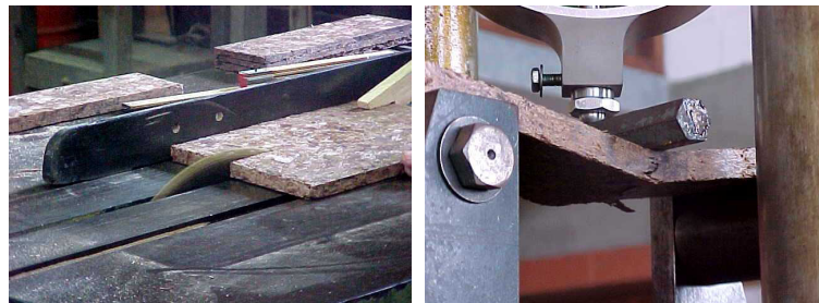
Figura 4 – Corte de corpos de prova e ensaio de flexão estática
