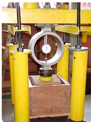
FIGURA 2 – Prensa construída no Laboratório de Madeiras e Estruturas de Madeira.
