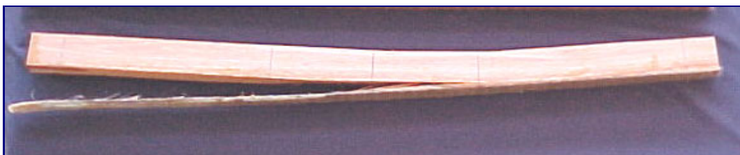
Figura 07: Ruptura por tração próxima a linha de cola
