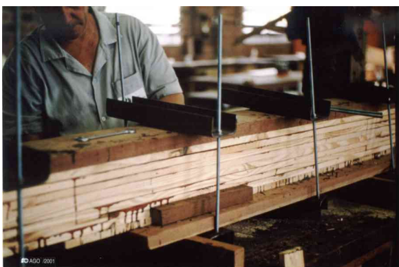
Figura 2 – Dispositivo de prensagem e colagem
