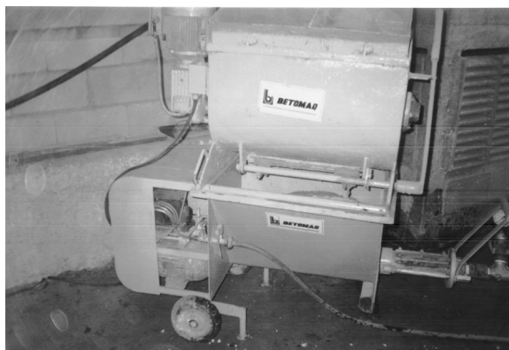
Figura 1 – Equipamento para projeção com misturador acoplado
