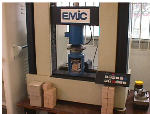
Figura 3.4.2 – Foto ilustrativa da prensa universal empregada nos ensaios de resistência à compressão e à tração (capacidade nominal 10 t.).
