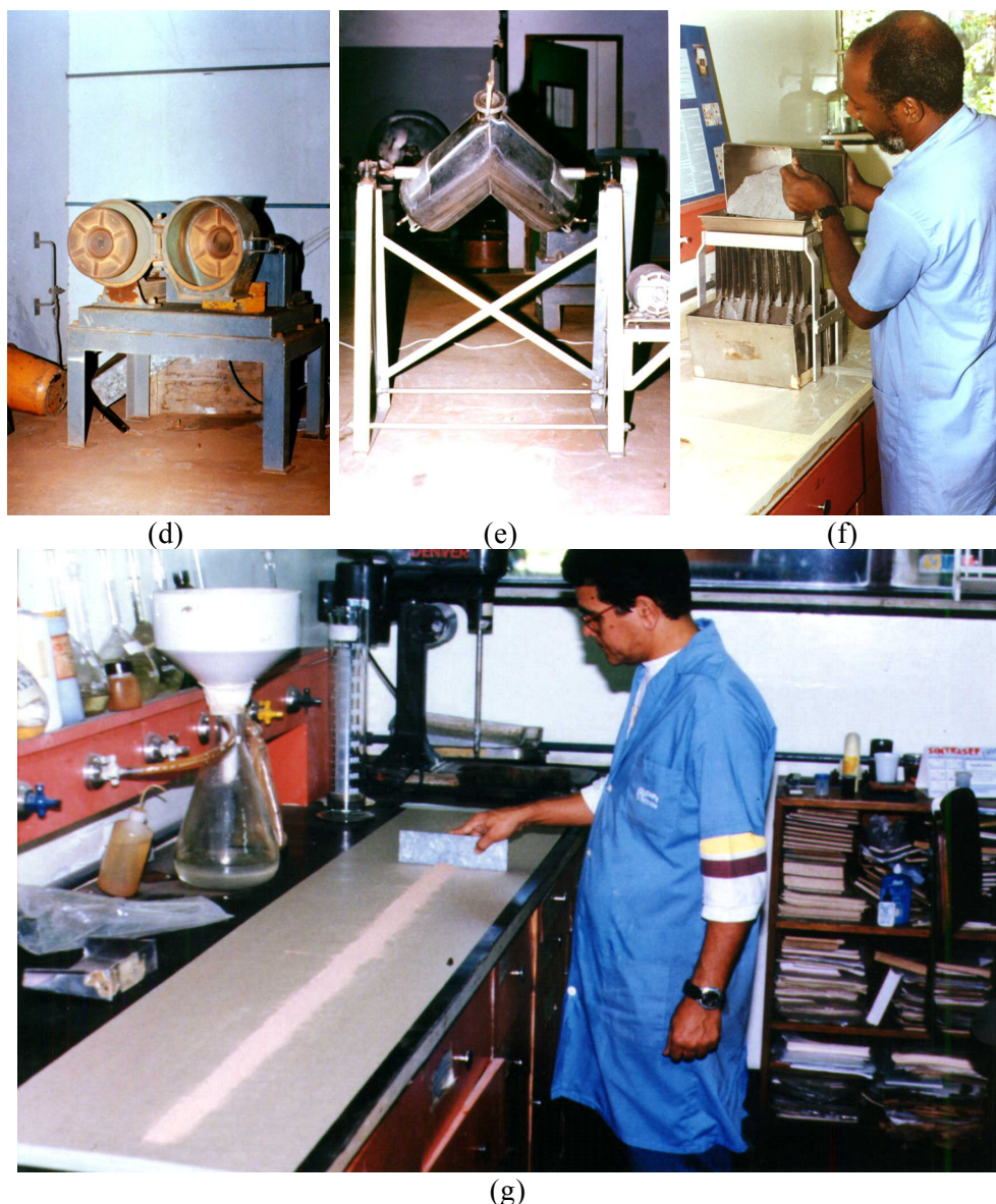
Figura 3 – Etapas de preparação das amostras para o teste de lixiviação
