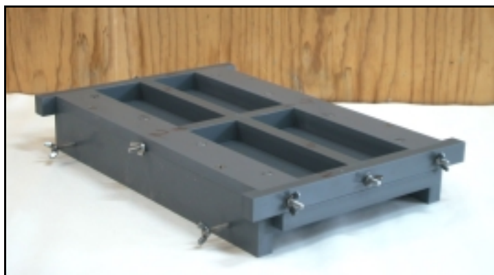
Figura 2 – Fotografia de forma de PVC para moldagem de corpos-de-prova de argamassa em forma de placa. O fundo do molde é removível, permitindo o encaixe de componente de alvenaria para moldagens sobre substrato poroso.
