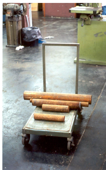
Fig. 04 – Tarugos a serem torneados para montagem do poste
