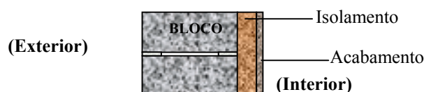
Figura 1 – Seção transversal típica de uma parede de vedação (RAHMAN, 1986).
