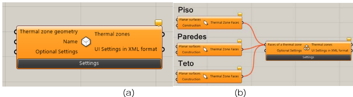
Figura 3: Modelagem de zonas térmicas a partir de uma geometria única (a) e por meio de superfícies (b)
