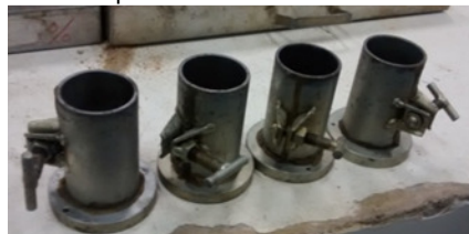
Figura 2 – Fôrmas para os corpos de prova cilíndricos
