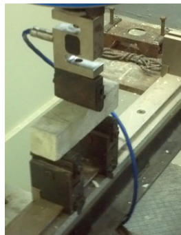
Figura 4 – Tração à flexão em corpos de prova prismáticos com determinação do deslocamento vertical.
