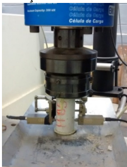
Figura 3 – Compressão simples em corpos de prova cilíndricos com determinação da deformação.
