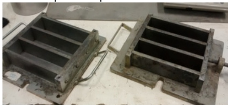
Figura 1 – Fôrmas para os corpos de prova prismáticos
