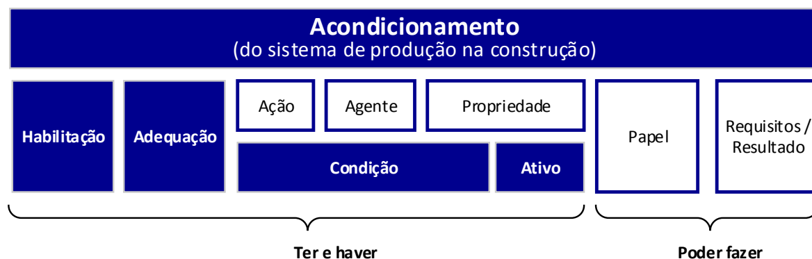
Figura 4 – Conceitos que compõem o processo de acondicionamento
