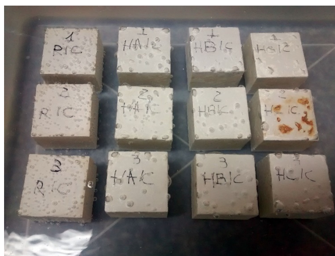
Figura 3 – Corpos de prova cúbicos de 5 x 5 x 5 cm, durante ensaio de absorção de água por imersão total
