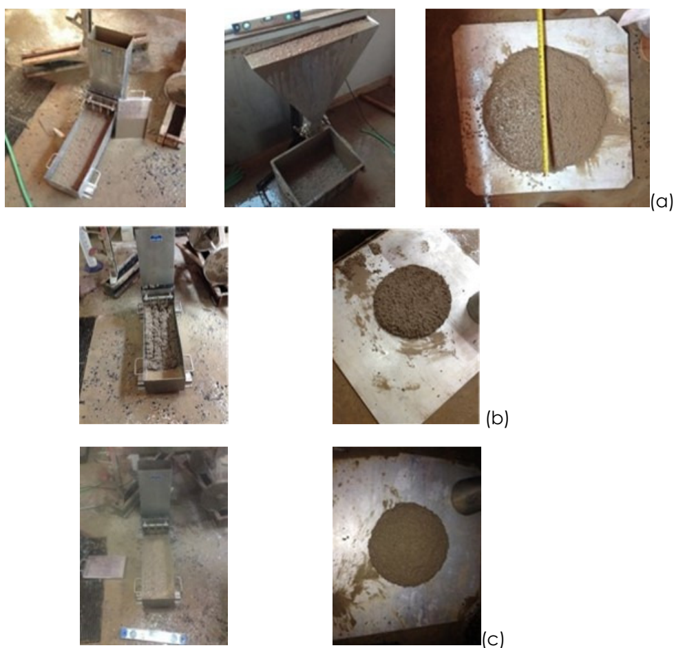
Figura 3 – Ensaios no CAA em estado fresco (a) CAA0F, (b) CAA25F, (c) CAA50F
