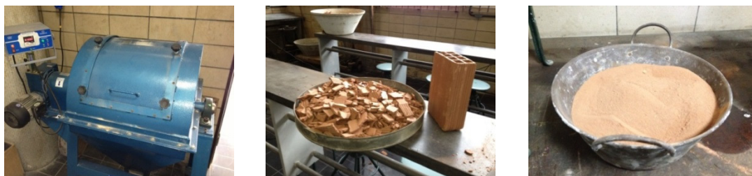
Figura 3 - Moinho, fragmentos do resíduo cerâmico e seu aspecto após a moagem
