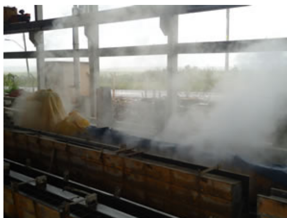
Figura 5 – Cura úmida a vapor
