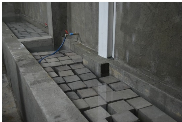
Figura 4 – Cura úmida por submersão
