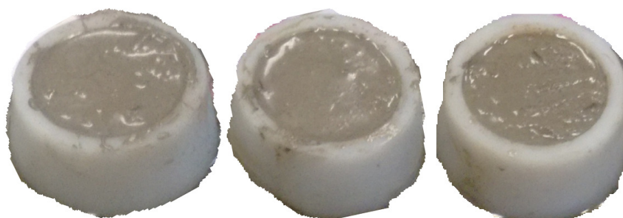
Figura 6 – Exsudação dos compósitos dosados com o aditivo I (Compensado, Eucalipto e Pinus)
