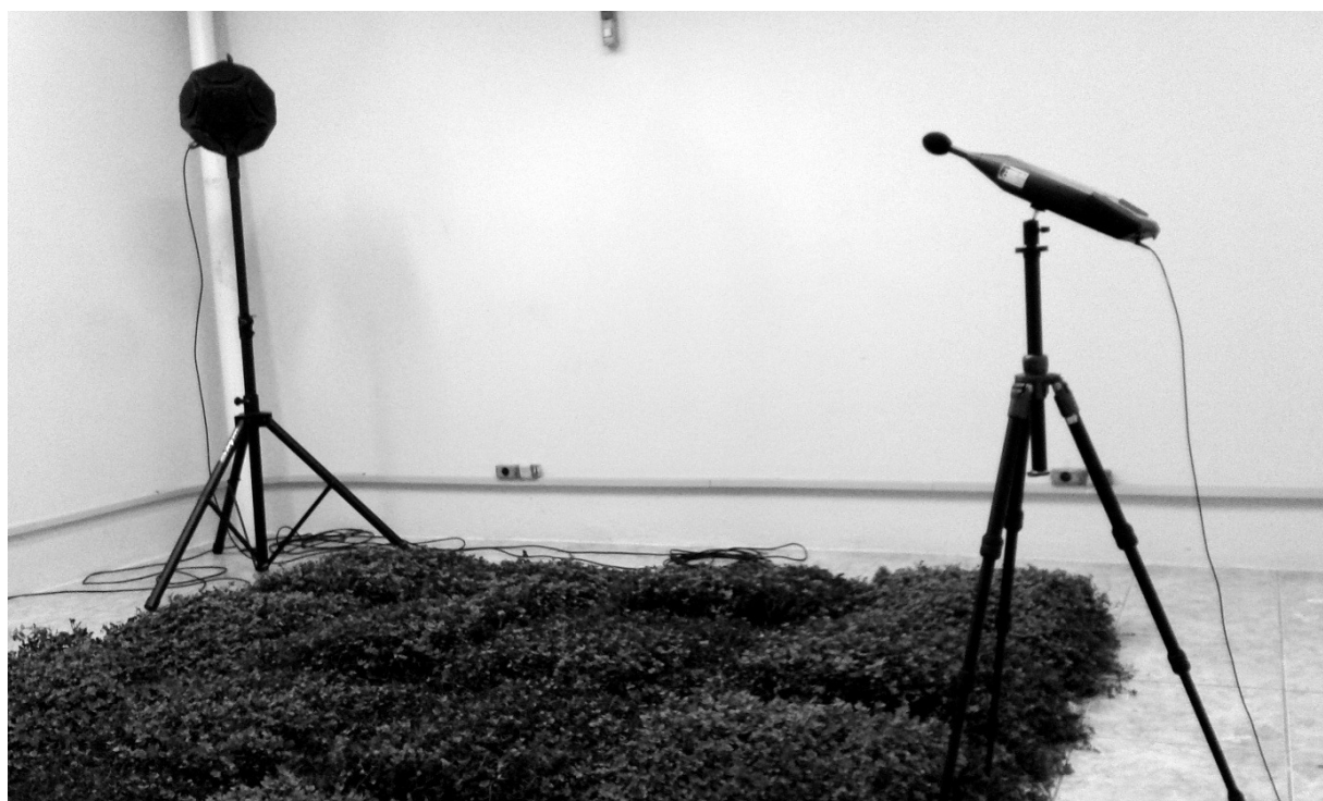
Figura 2 – Montagem da configuração III na câmara de reverberação
