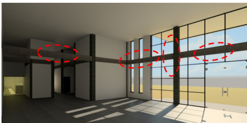
Figura 2 – Incompatibilidade do pilar PG47, viga VG11 e duas janelas J9, do bloco G, com o sistema de cortina vidraça na entrada do ambiente de espera.
