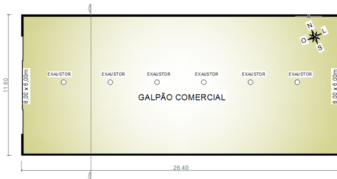
Figura 3 – (a) Planta baixa do objeto de estudo com a localização dos exaustores instalados na cobertura e (b) corte transversal esquemático
