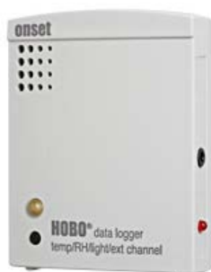
Figura 4 – Sensor de iluminância interna modelo HOBO U12-013
