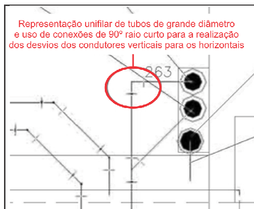
Figura 5 – Condutor horizontal com mudança de direção em 90°.
