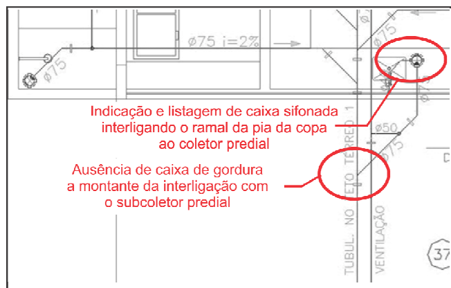
Figura 4 – Inexistência de caixa de gordura.
