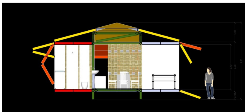
Figura 9- Corte esquemático - instalação sanitária, cozinha e Estar.
