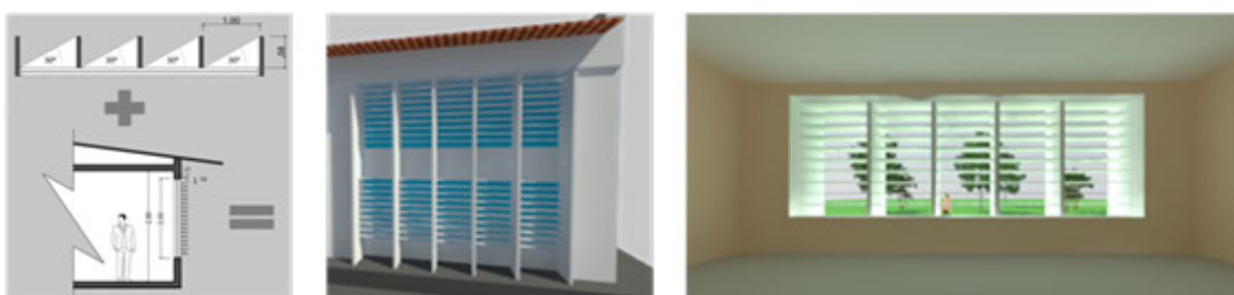
Figura 14 – Combinação 3: Esquema em planta, corte, perspectiva externa e interna
