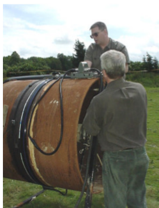
(a) Técnica de radiografia digital direta em uma solda de tubulação
