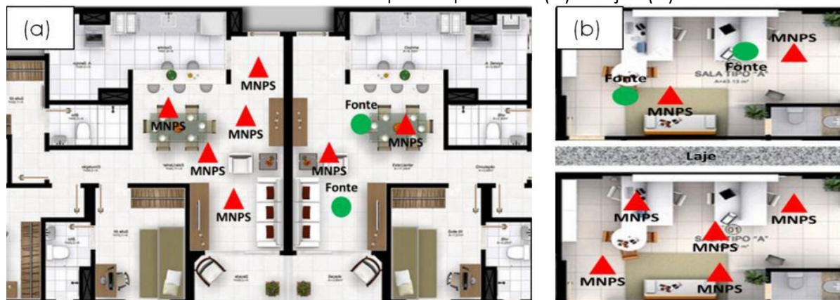
Figura 2 – Arranjos dos equipamentos de medição nos ensaios de isolamento ao ruído aéreo em campo de paredes (a) e lajes (b)
