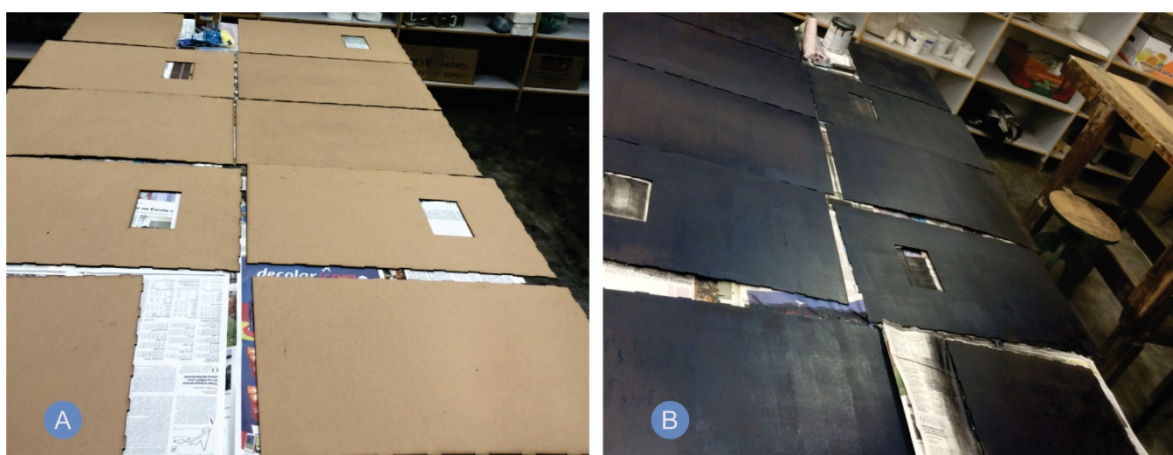
Figura 3 - Pintura interna das superfícies de preto fosco
