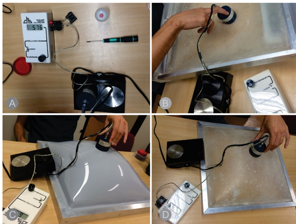
Figura 6 – Ensaio de emissividade das superfícies da pesquisa
