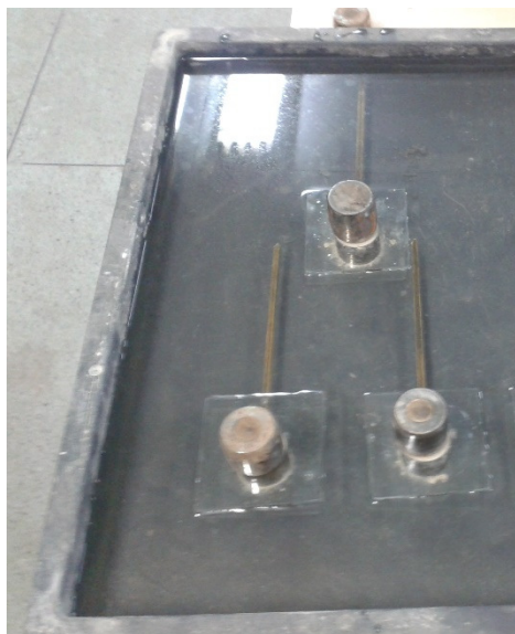
Figura 4 – Ensaio de expansibilidade a quente do novo clínquer
