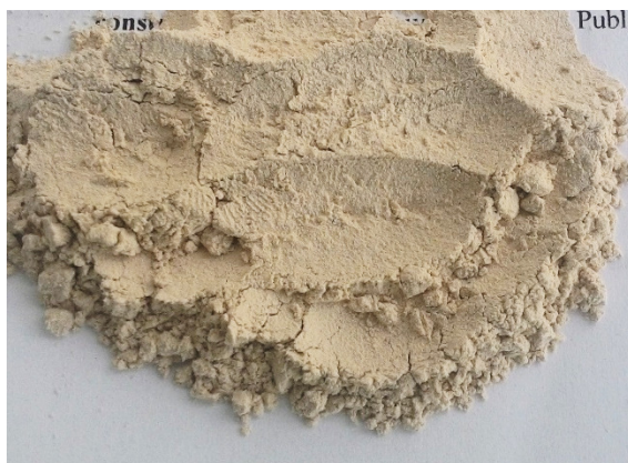
Figura 2 – Material obtido após a calcinação da mistura de resíduos e ser submetido ao moinho de bolas
